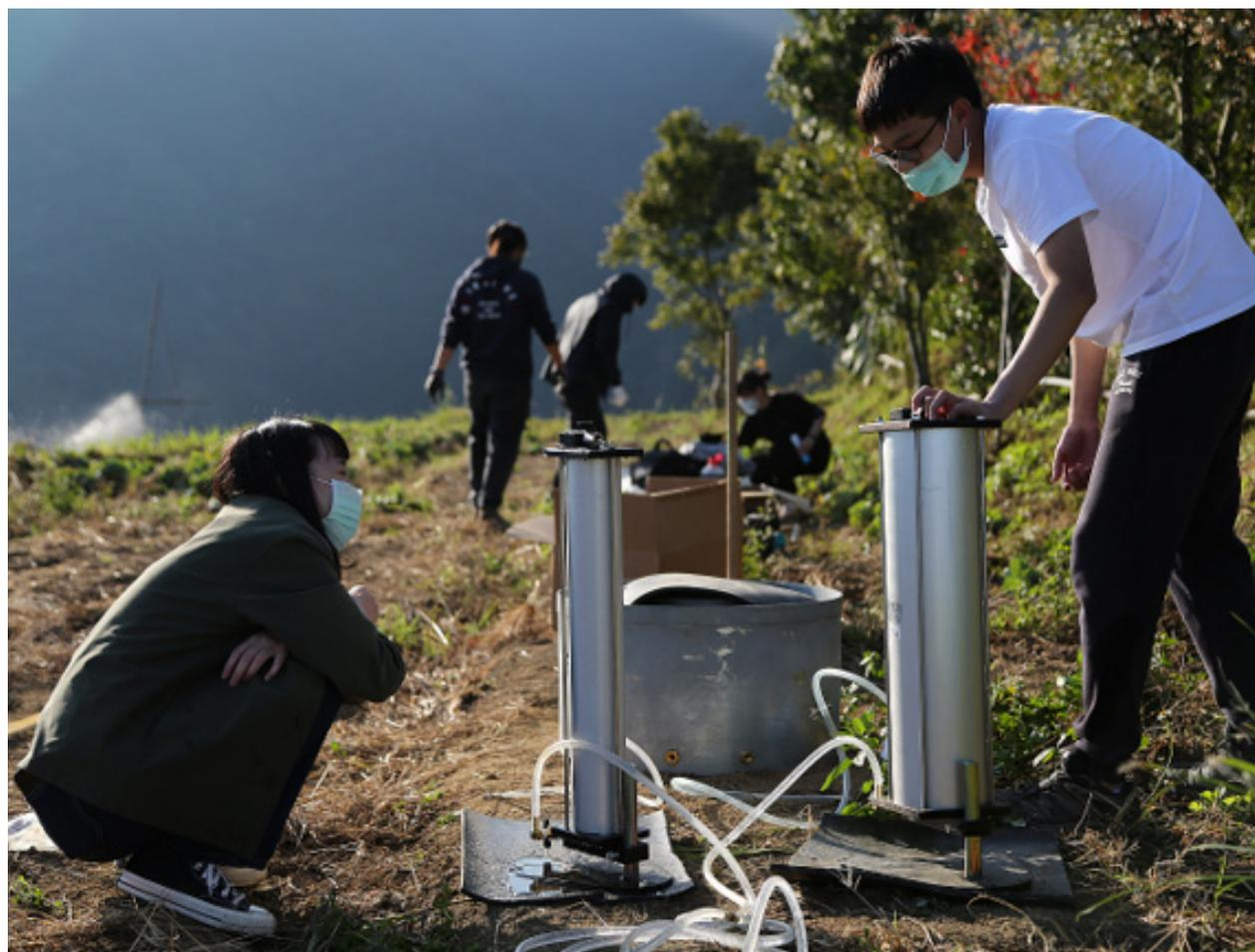
學專業，體現自身的專業以對社會和人群有所貢獻，不僅提高學習的動機和推力，還能陶冶人文素養的胸襟。課程中以循序漸進的方式教導學生山坡地災害的種類及生態工法的災害防治相關知識，包含前往場域與居民訪談而後開始進行一連串的防災取樣研究，師生團隊前往石磊部落拍攝邊坡超高分解度影像，以進行落石監測的比對，提高評估落石風險的可行性，這些影像在將來實際應用中，可以為工程師提供有價值的參考資訊，幫助他們制定落石防護措施，以確保行人和車輛的安全。並透過評估土壤滲透性的重要工具，於部落進行現地透水試驗，取回土壤樣本進行篩分析和有機質試驗，以及進行現地無人機空拍，製作正射影像和打印周遭環境 3D 模型，以使用於後續的教學展示和分析。相關人員積極投入，依照計畫執行架構和團隊分工，以土木系為中心進行溝通和協調。最後學生們透過課程的學習和專家講座，以及實際前往現地等培訓過程，完成了知識的整理並製作海報，將結果回饋給部落居民。
