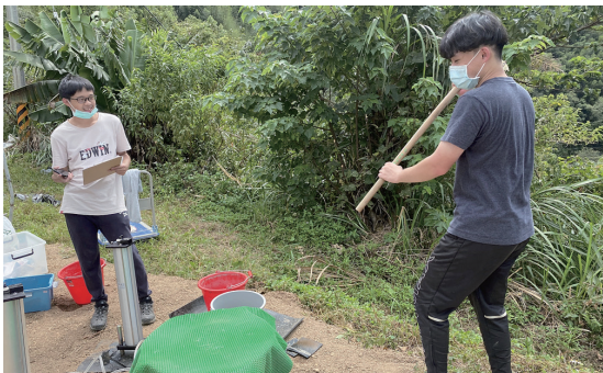
▲ 透水試驗能夠協助我們了解降雨時土壤水分的滲透速率，進而預估地表逕流的大小以及分析土壤在降雨時是否容易產生水土流失，以有效保護土地資源並防止土地劣化。
