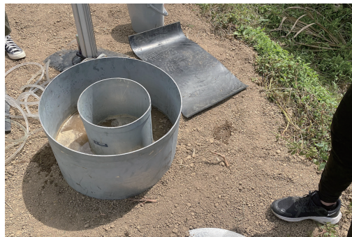
▲ 透水試驗能夠協助我們了解降雨時土壤水分的滲透速率，進而預估地表逕流的大小以及分析土壤在降雨時是否容易產生水土流失，以有效保護土地資源並防止土地劣化。
